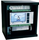
**Cabinet 10" metallico per montaggio a muro** completo di ventolina di raffreddamento termostata, alimentatore 230Vac 250W, 24Vcc, 10,4A e scheda di distribuzione delle alimentazioni.
