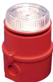
**Avvisatore ottico acustico a sicurezza intrinseca**, 49 toni alti in 100 dB (A); LED estremamente luminosi di colore rosso, regolazione del volume, utilizzabile come unità combinata o separatamente. Alimentazione 24Vcc, 48mA. Contenitore in ABS di colore rosso, diametro 88mm. Grado di protezione IP65, temperatura di esercizio -40°C a +60°C. Marcatura II 1G Ex ia IIC T4 - 40 °C + 60 °C Ta per Zona 0,1,2. Certificazione SIRA 05 ATEX2084 X / SIRA. Necessita di barriera a sicurezza intrinseca.
