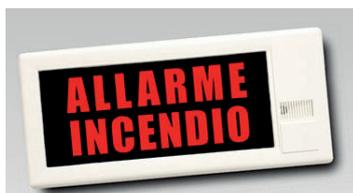
**Pannello ottico/acustico con buzzer**, LED ad alta efficienza, suono pulsante, potenza acustica min. 79db(A) 1m MAX 92,3 dB(A), alimentazione 18-30dc, assorbimento a 24Vcc 50mA, temperatura di funzionamento -10°C +55°C. Contenitore in termoplastico autoestinguente BIANCO completo di scritta "ALLARME INCENDIO", grado di protezione IP21C. Dimensioni 292x130x55mm. Certificato EN 54-3, UNI11744
