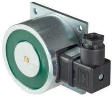
Fermo elettromagnetico per porte tagliafuoco con forza di ritenuta 150 Kg. - 1500 N, terminali a filo, alimentazione 24V, assorbimento 100mA, corpo magnete in acciaio nichelato e resinato e base in acciaio zincato. Grado di protezione IP65. Completo di ancoraggio fisso S02. dim. 75x115x43. Certificato UNI EN 1155:2003
