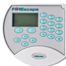
**Tastiera della centrale di controllo** per l'illuminazione di emergenza da utilizzare con la centrale NEPTO-3K. La centrale di controllo viene comandata e controllata tramite il display grafico LCD retroilluminato e compatto della tastiera, che può visualizzare lo stato del sistema delle unità di illuminazione, inclusi la carica della batteria e i guasti ai LED.
