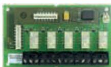
**Scheda 5 uscite a relè addizionali** per unità aspirazione ASD 531 e 532. I relè sono liberamente programmabili (solo per ASD 532) per le segnalazioni di Guasto, Allarme e Pre-allarme. Max. 2 schede per unità di aspirazione ASD 532, max. 1 scheda per ASD 531. Dimensioni: 95x58x17 mm (HxLxP)
