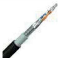
Cavo twistato schermato alluminio + calza in rame stagnato 2 x 2 AWG24. Isolamento conduttori in PE, guaina esterna termoplastico LSZH di colore verde. Isolamento guaina 400V. Guaina esterna diametro 8,0mm. Impedenza caratteristica: 120 ohm, mutua capacità 43pF/m. Conforme alle norme: CEI EN 60332-1-2, IEC 754-1/2, IEC 61034, CEI-UNEL 36762, EIA RS485. Classificazione secondo EN50575: Cca-s1a,d1,a1.
