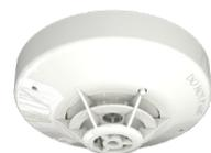
**Rivelatore combinato termovelocimetrico + termico** a risposta statica 60°C indicati dalla lettera "A", corrispondente alla "Classe A" e alla "Classe AR" nella classificazione EN54. Doppio led di segnalazione allarme visibile a 360°. Morsetto di uscita per lampada ripetitrice. Alimentazione 9,5-30 Vdc. Basso profilo altezza 39mm, diametro 100mm. Certificato EN 54-5: 2000 + A1:2002. Compatibile con le basi della serie YBN-R/6 e YBO-R/6.
