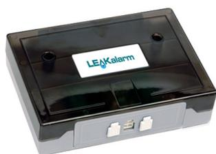
**Modulo indirizzato su loop** per 2 zone di rivelazione perdita acqua. Massima lunghezza gestita del cavo sensore 50m per zona. Led di segnalazione visibile a coperchio chiuso. Indirizzamento tramite dip switch presenti sul modulo.
