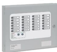
**Pannello ripetitore 24Led SYNCRO IDENT24**, Connessione alla centrale tramite RS485. Munito di Buzzer, comandi di tacitazione/riattivazione e Lamp test. Alimentazione da 18-30Vcc. Dimensioni 385x310x60 mm. Contenitore in acciaio verniciato grigio BS-00-A-05, colore frontale grigio RAL7047.
