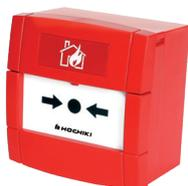
**Pulsante incendio convenzionale ripristinabile** in MPO colore ROSSO, completo di scatola posteriore (SR). Uscita con contatto NA libero o con in serie resistenza da 470 Ohm. Temperatura di funzionamento -10°C +55°C. Grado di protezione IP24. Dimensioni Pulsante 89x93x27,5 mm. Dimensioni Pulsante completo di scatola posteriore 89x93x59,5 mm. Certificato EN 54-11.
