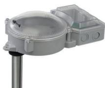
Camera di analisi per condotte d'aria compatibile con le basi YBN-R/3, YBN-R/3(SCI), YBN-R/6, YBN-R/6SK, YBO-R/6R, YBO-R/6RN, YBO-R/6RS e loro varianti. Compreso tubo di campionamento per presa/rimando da 600mm (deve essere praticato un solo foro sulla condotta), struttura in ABS con camera ispezionabile, dimensioni esterne 280x150x100 mm. Direttamente installabile su canali d'aria a sezione quadrata mentre per quelle a sezione circolare richiede le staffe di montaggio SDP-3 BRAKET.
