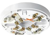
Base per rivelatori convenzionali serie CDX, con uscita a relè NON memorizzante portata dei contatti 1A 30Vdc carico non induttivo, contatti ad innesto autopulenti, morsetto d'appoggio per schermo, altezza 13 mm, diametro 100 mm.
