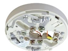
Base per rivelatori convenzionali serie CDX, con uscita a relè memorizzante portata dei contatti 1A 30Vdc carico non induttivo e diodo Schottky, contatti ad innesto autopulenti, morsetto d'appoggio per schermo, altezza 13 mm, diametro 100 mm.
