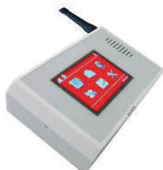
Combinatore telefonico GSM Touchscreen. 6 messaggi vocali, 25 messaggi SMS, fino a 1000 numeri telefonici, 4 uscite a relè programmabili. Temperatura di funzionamento 0-45°C, alimentazione da 10,5 a 30Vdc assorbimento a riposo max 90mA, in allarme max 300mA + 20mA per ogni uscita a relè attivata.
