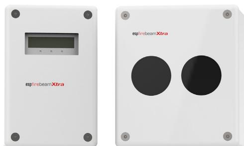
Rivelatore lineare ottico di fumo da collegare direttamente al loop con protocollo Hochiki ESP; riflettore (FBX-REFLECTOR) incluso per portata nominale 5-70 m. Estendibili a 140m e 160 m tramite kit aggiuntivi di riflettori. Gruppo ottico motorizzato autoallineante. Configurazione parametri tramite unità di controllo separata, installata a terra (compresa). Temperatura di funzionamento -10°C +55°C 95%RH. Grado di protezione IP65 Certificato EN 54-5:2000 + A1:2002 e EN 54-7:2000 + A1:2002.
