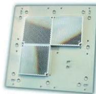
Riflettore anti-appannaggio per ESPFIREBEAMXTRA per portata da 70m a 140m. La superficie del riflettore è trattata con una speciale finitura (Nano technology). Ideale in ambienti con umidità elevata.
