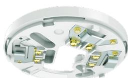
**Base standard per rivelatori analogici serie Ferroviaria**, contatti ad innesto autopulenti, morsetto d'appoggio per schermo, altezza 8 mm, diametro 100 mm, peso 50 g. Materiale ABS, colore BIANCO. Range temperatura funzionamento certificato da -25°C a +70 °C. Certificata EN50155.
