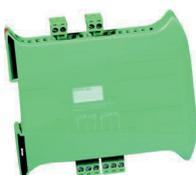
**Modulo indirizzato su loop per 2 zone rivelatori convenzionali (20/zona) a sicurezza intrinseca**, alimentazione esterna 24Vdc, consumo a riposo 330 microA. Contenitore di montaggio da barra DIN e morsetti estraibili. Temperatura di funzionamento -10°C +50°C. Dimensioni 119x108x24mm. Con isolatori di corto circuito integrati nel modulo. Certificato EN 54-18 ed EN 54-17. Please add: Necessita di barriera a sicurezza intrinseca.
