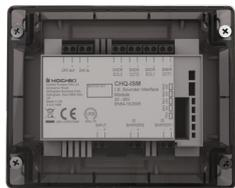
**Modulo di interfaccia per avvisatori ottico-acustici a sicurezza intrinseca** collegati ai moduli avvisatori CHQ-DSC2(SCI) o alle uscite avvisatori di centrale. Dotato di 2 uscite per avvisatori (max. 1 avvisatore o lampeggiante per uscita) e 1 ingresso monitorato. Alimentazione esterna 24Vcc. Contenitore "Smart Fix" con coperchio trasparente. Dimensioni 157x127x35mm. Certificato EN 54-18:2005. Necessita di barriera a sicurezza intrinseca.
