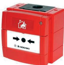
**Pulsante incendio** con protocollo ESP completo di isolatore di corto circuito, ripristino con apposita chiavetta in dotazione che non richiede la sostituzione dell' elemento infrangibile. Costruzione in MPO di colore ROSSO. Consumo tipico 250 microA a riposo e 5 mA in allarme. Grado di protezione IP67. Dimensioni pulsante 98x94x78 mm. Certificato EN 54-11 ed EN 54-17. Necessita di programmatore portatile TCH-B200 tramite cavetto PL-3 per l'indirizzamento.
