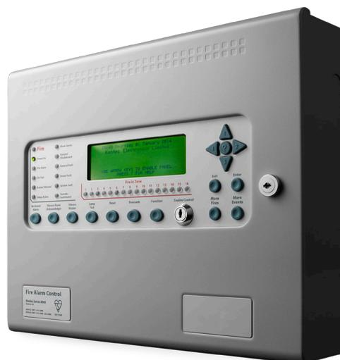
**Pannello ripetitore Syncro View** per centrali Syncro. Display grafico LCD 240 x 64 pixels. Ripete esattamente la centrale sia a livello di segnalazioni che di comando. Con chiave di abilitazione. Alimentazione 24Vdc. Dimensioni 330 x 255 x 90mm.
