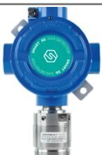
Rivelatore serie SMART3G-C2 per OSSIGENO (O2); Campo di misura 0-25% Vol. Uscita proporzionale 4-20mA. Uscite opzionali a relè tramite scheda ST.S3REL. Alimentazione 12-24Vcc. Temperatura di esercizio: -30°C/50°C.
