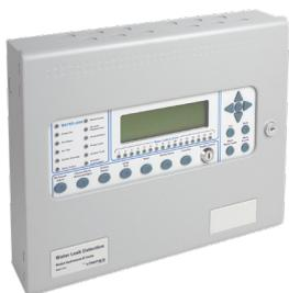
Centrale antiallagamento LEAKalarm con 1 Loop per 127 dispositivi (protocollo ESP), display grafico 240x64 pixel, espandibile a 2 loop con scheda, gestione nella massima configurazione di 254 sensori perdita acqua per un totale di 12.700 m di cavo sensore. Batterie in tampone richiesta: 2x7 Ah/12V (esclusa). Alimentatore 3A-24Vcc. Armadio metallico 385x310x90 mm.
