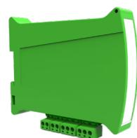
Modulo indirizzato su loop per 2 zone rivelatori convenzionali (30/zona) o rivelatori lineari di fumo SPC-ET (max 3 per zona), alimentazione esterna 24 Vdc, consumo a riposo 330 microA. Led di segnalazione. Contenitore per montaggio su barra DIN. Morsettiere estraibili. Dimensioni 119x108x24mm. Completo di isolatori di corto circuito integrati direttamente sul modulo. Certificato EN 54-18 ed EN 54-17. Indirizzamento tramite dip switch presenti sul modulo.
