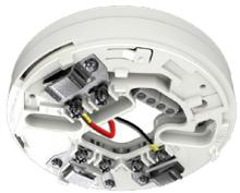
**Base con isolatore di corto circuito per rivelatori analogici** serie ASX, numero 3 contatti ad innesto autopulenti compreso morsetto d'appoggio per schermo, apposita morsettiera per il collegamento al loop, altezza 13,7 mm, diametro 100 mm, peso 79 g. Certificata EN 54-17.
