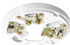
Base per rivelatori convenzionali serie CDX, con uscita a relè NON memorizzante portata dei contatti 1A 30Vdc carico non induttivo e diodo Schottky, contatti ad innesto autopulenti, morsetto d'appoggio per schermo, altezza 13 mm, diametro 100 mm.
