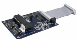
**Interfaccia FIRELINK Apic** con Protocollo Hochiki ESP per interfacciamento su Loop analogico centrali incendio. Può essere installata sulle unità serie FIRELINK e fornisce indicazioni sullo stato dell'unità di aspirazione (o di più unità di aspirazione se installata su FIRELINK 400CM O FIRELINK-CM) direttamente sulla centrale rivelazione incendio.
