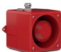
**Avvisatore acustico in esecuzione antideflagrante** per applicazioni industriali gravose o navali. 32 toni selezionabili, pressione sonora 105dB. Contenitore in alluminio di colore rosso, grado IP67. Temperatura di esercizio -25°C a +55°C. Alimentazione 24Vcc, 280mA. Marcatura II 3G Ex nA II T4, II 3D Ex tD A22 IP 67 T135°C per Zona 2 e 22. Certificato EN54-3 e GL per impiego navale
