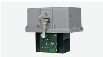
**Rivelatore ottico ad alta sensibilità** per unità di analisi ASD 531. Sensibilità allarme: min. 10%-max.0.02 %. Il preallarme può essere impostato fino a 10 volte più sensibile. Es. 0.002% obs/m. Temperatura di lavoro -20°C a +60°C. Dimensioni: 95 (L) x 145 (H) x 120 (P) mm.
