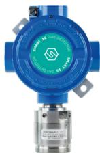
Rivelatore serie SMART3G-C2 per MONOSSIDO DI CARBONIO (CO); Campo di misura 0-500ppm L.I.E. Uscita proporzionale 4-20mA. Uscite opzionali a relè tramite scheda ST.S3REL. Alimentazione 12-24Vcc. Protezione IP65. Temperatura di esercizio: -30°C/55°C.
