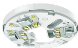
**Base standard** per rivelatori analogici serie ASX, contatti ad innesto autopulenti, morsetto d'appoggio per schermo, altezza 8 mm, diametro 100 mm, peso 50 g. Materiale ABS di colore AVORIO.
