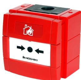
**Pulsante incendio convenzionale ripristinabile** in MPO di colore ROSSO, versione weatherproof, completo di vetrino infrangibile antinfortunistico. Uscita con contatto NA libero o con in serie resistenza da 470 Ohm. Temperatura di funzionamento -25°C +70°C. Grado di protezione IP67. Dimensioni 98x94x78 mm. Certificato EN 54-11. Approvazione DNV-GL.
