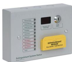
Ripetitore remoto distato Sigma SI-XL per centrale SigmaXT, SigmaXT+ e SyncroXT+. N. 10 segnalazioni luminose (anche Allarme Incendio Zone 1, 2 e 3 e Guasto) + display tempo rimanente. Completo di Chiave Meccanica per selezione modalità di funzionamento Automatico/ Manuale. Pulsante a strappo per Comando Manuale Scarica Immediata. Collegamento tramite linea seriale. Alimentazione 21-30 Vcc. Consumo: 33 mA. A riposo/ 70 mA. Max. in allarme; Box Metallico colore grigio RAL 7047 dim. 385x310x90 mm.
