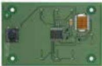
Scheda display di ricambio per unità aspirazione standard sistemi SECURIRAS ASD535-1 e ASD535-2 (senza led livello intensità fumo). Dimensioni: 90x59x9mm (HxLxP)
