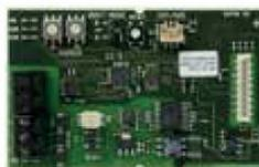
**Scheda interfaccia RS-485** per la connessione dell'unità di aspirazione ad un PC o per il collegamento in rete con le altre unità di aspirazione (max. 255) Per sistemi SECURIRAS ASD532 e ASD535. Dimensioni: 95x58x17 (HxLxP).
