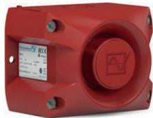
**Sirena elettronica** completa di backbox per entrata cavi, potenza acustica 100 dB (portata EN54 r=18m), 80 toni selezionabili, alimentazione 10-57Vdc assorbimento 6-80mA, temperatura di funzionamento -40° +55°C. Contenitore in policarbonato e ABS di colore ROSSO, dimensioni 110x86x80 mm (LxHxP). **Grado di protezione IP66**. Certificata EN 54-3, VdS, GOST, UL, GL (codice d'ordine specifico per GL).
