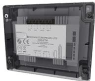
**Modulo indirizzato su loop con 2 ingressi** di corrente nominale 4-20mA range operativo 0-25,5mA, consumo sul loop a riposo 330 microA. Led di segnalazione visibili a coperchio chiuso. Contenitore "Smart Fix" con coperchio trasparente. Dimensioni 157x127x35mm. Certificato EN 54-18:2005. Indirizzamento tramite dip switch presenti sul modulo. **NOTA: Verificare compatibilità con la centrale.**
