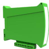
Modulo indirizzato su loop con 4 ingressi monitorati e 4 uscite a relè con contatto in scambio libero da tensione, portata 30Vcc/1A (carico resistivo). Alimentazione diretta da loop, consumo a riposo 300 micro A. Led di segnalazione. Contenitore per montaggio su barra DIN. Morsettiere estraibili. Dimensioni 119x108x24mm. Completo di isolatori di corto circuito integrati direttamente sul modulo. Certificato EN 54-18 ed EN 54-17. Indirizzamento tramite dip switch presenti sul modulo.
