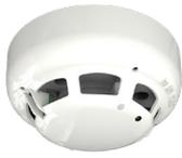
**Rivelatore combinato termomassimale + termovelocimetrico analogico indirizzato**, indirizzamento elettronico, doppio Led di segnalazione (verde in polling, rosso in allarme), consumo 350 microA, basso profilo, altezza 45mm, diametro 100 mm. Certificato EN54-5. Compatibile con le basi della serie YBN-R/3, YBN-R/3(SCI) e YBV-R/4 in funzione del colore del rivelatore. Necessita del programmatore portatile TCH-B200 per l'indirizzamento.
