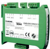
Modulo indirizzato su loop con 1 ingresso monitorato 2 uscite controllate per avvisatori (carico max. 1A ognuna). Alimentazione esterna 24Vcc 2A, consumo sul loop a riposo 350 microA. Led di segnalazione. Contenitore per montaggio su barra DIN. Morsettiere estraibili. Dimensioni 119x108x24mm. Completo di isolatori di cortocircuito integrati direttamente sul modulo. Certificato EN 54-18:2005 ed EN 54-17:2005. Indirizzamento tramite dip switch presenti sul modulo.
