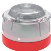
**Lampeggiante a led ROSSO** alimentazione 12-29Vdc assorbimento massimo 26mA, temperatura di funzionamento -25°C +70°C. Contenitore in materiale termoplastico di colore rosso o bianco, con lente trasparente, altezza 72mm diametro 100mm. Grado di protezione IP21C. Certificata EN 54-23 classe C e W.
