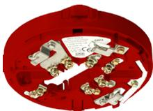
**Base con isolatore di corto circuito per sirene** CHQ-WS2 e CHQ-WSB2/, numero 3 contatti ad innesto autopulenti compreso morsetto d'appoggio per schermo, altezza 13 mm, diametro 100 mm, peso 60 g. Certificato EN 54-17:2005. Colore ROSSO.
