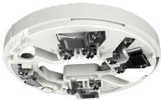
**Base standard per rivelatori analogici** serie ASX con isolatore, numero 4 contatti ad innesto autopulenti compreso morsetto d'appoggio per schermo, altezza 8 mm, diametro 100 mm, peso 50 g. Colore BIANCO.
