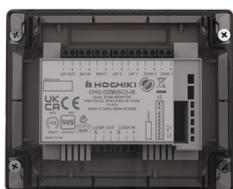
**Modulo indirizzato su loop per 2 zone rivelatori convenzionali (20/zona) a sicurezza intrinseca**, alimentazione esterna 24Vdc, consumo a riposo 330 microA. Led di segnalazione visibile a coperchio chiuso. Contenitore "Smart Fix" con coperchio trasparente. Temperatura di funzionamento -10°C +50°C. Dimensioni 157x127x35mm. Con isolatori di corto circuito integrati nel modulo. Certificato EN 54-18 ed EN 54-17. Necessita di barriera a sicurezza intrinseca.
