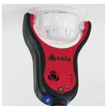
Nuovo tester SOLO365, kit completo per il test dei rivelatori di fumo con cartuccia intercambiabile e non più su bombolette spray.
