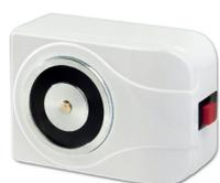
Fermo elettromagnetico per porte tagliafuoco con pulsante di sblocco, forza di ritenuta 100 Kg. - 1000 N, terminali a filo, alimentazione 24V, assorbimento 100mA, corpo magnete in acciaio nichelato e base in materiale plastico, colore bianco. Completo di ancoraggio snodato. dim. 72x105x52. Certificato UNI EN 1155:2003
