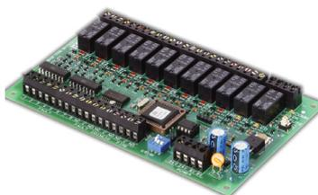
**Scheda remota a 8 uscite ausiliarie controllate per avvisatori.** Collegamento alla centrale tramite linea seriale RS-485. Le uscite possono essere programmate per funzionare in modalita` Comune, di Zona e a 2 Stati. Ogni uscita puo` fornire al massimo 0,5 A. Tensione di alimentazione 20-30Vcc. Consumo max. 4A in allarme.
