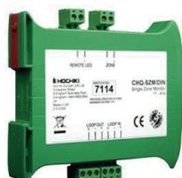
Modulo indirizzato su loop per 1 zona di rivelatori convenzionali (max. 6) o per un rivelatore lineare SPC-ET o SRA-ET. Alimentazione diretta dal loop, consumo a riposo 260 micro A. Led di segnalazione. Contenitore per montaggio su barra DIN. Morsettiere estraibili. Dimensioni 119x108x24mm. Completo di isolatori di corto circuito integrati direttamente sul modulo. Certificato EN 54-18:2005 ed EN 54-17:2005. Indirizzamento tramite dip switch presenti sul modulo.
