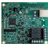
**Scheda di rete RS485** da inserire nella centrale serie Latitude. Consente il collegamento in rete ad anello tra centrali e pannelli remoti per complessivi 64 (in test 127) nodi.
