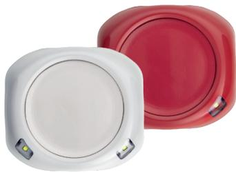
**Lampeggiante convenzionale** con flash bianco tipo "W", alimentazione 9-60Vdc, assorbimento 11mA, temperatura di funzionamento -10°C +55°C 95%RH. Contenitore in ABS e lente in PLC. Dimensioni 62X118X106 (HXWXL). Grado di protezione IP65. Certificato EN54-23.
