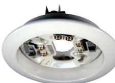
Adattatore per montaggio ad incasso dei rivelatori serie ASX e CDX. Materiale in ABS. Compatibile con le basi della serie YBN, YBO-R/5, YBO-R/6, YBO-R/4, YBV-R/4. Altezza 44 mm (incassato 7mm), diametro 140 mm, peso 65 g. Deve essere completato con il fissaggio cod. YYA-1 per controsoffitto
