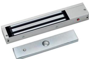
Fermo elettromagnetico per porte di sicurezza. Utilizzato generalmente per mantenere chiuse le porte di sicurezza, uscite di emergenza, porte antipanico, di accesso e di passaggio in generale. Forza di tenuta 500Kg. Alimentazione 12/24Vdc assorbimento 450/255mA. Led indicatore di stato e relàcon contatti NA/NC. Dimensioni 250x48x24. Completo di contropiastra dimensioni 185x61x16,5.
