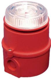
**Avvisatore ottico a sicurezza intrinseca**, dotato di LED estremamente luminosi di colore rosso. Alimentazione 24Vcc, 25mA. Contenitore in ABS di colore rosso, diametro 88mm. Grado di protezione IP65, temperatura di esercizio -40°C a +60°C. Marcatura II 1G EEx ia IIC T4 per Zona 0,1,2. Certificazione SIRA 05 ATEX2084 X / SIRA. a sicurezza intrinseca.
