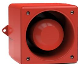
**Avisatore acustico in esecuzione antideflagrante** per applicazioni industriali gravose o navali. 32 toni selezionabili, pressione sonora 105dB. Alimentazione 24Vcc assorbimento 280mA. Temperatura di funzionamento -25°C a +55°C. Grado di protezione IP67. Contenitore in alluminio di colore ROSSO. Marcatura II 3G Ex nA II T4, II 3D ExtD A22 IP 67 T135°C per Zona 2 e 22. Certificato EN54-3 e GL per impiego navale.
