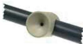
**Punto d'aspirazione** per installazioni con circolazione aria molto elevata (rivelazione su condizionatori d'aria o su rack ventilati). Si applica direttamente sulle tubazioni. Materiale ABS, diametro foro 5mm.
