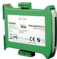
Modulo indirizzato su loop a 2 ingressi singolarmente programmabili come N/A o N/C. Alimentazione diretta dal loop, consumo a riposo 280 micro A. Led di segnalazione. Contenitore per montaggio su barra DIN. Morsettiere estraibili. Dimensioni 119x108x24mm. Completo di isolatori di corto circuito integrati direttamente sul modulo. Certificato EN 54-18:2005 ed EN 54-17:2005. Indirizzamento tramite dip switch presenti sul modulo.
