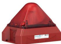
**Lampeggiante allo xeno per interni/esterni.** Energia flash 5 Joule, intensità luminosa 44 cd (portata EN54r=11m) frequenza flash selezionabile 0,1/0,5/0,75/1Hz. Alimentazione 10-60Vdc assorbimento 280mA a 24Vdc, contenitore in policarbonato e ABS di colore ROSSO. Dimensioni 166x114x124 mm (LxHxP forma piramidale). Grado di protezione IP66. Temperatura di esercizio -40° +55°C. Certificata EN54-23, VdS, UL.
