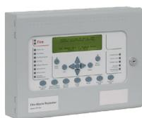
**Pannello ripetitore SYNCRO VIEW-A** per centrali SYNCRO. Display grafico LCD 240 x 64 pixels. Ripete esattamente la centrale sia a livello di segnalazioni che di comando. Completo di alimentatore-carica batterie 230Vca-750mA e chiave di abilitazione. Batterie allocabili 2x1,9Ah-12V. Dimensioni 330 x 250 x 90mm.
