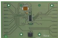
Scheda display di ricambio per unità aspirazione "advance" sistemi SECURIRAS ASD535-3 e ASD535-4 (con led livello intensità fumo). Dimensioni: 90x59x9mm (HxLxP)
