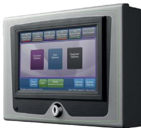
**Pannello remoto VISION** con display LCD grafico a colori da 7", 800x480 pixels con funzionalità Touch-screen di tipo resistivo e attenuazione automatica della retroilluminazione, completo di scheda di rete RS485 cod. HLA-AP-LNC. Consente la ripetizione di tutte le informazioni delle centrali L@titude in rete e la piena operatività della centrale. Grado di protezione IP30 peso 2Kg dimensione 235(L)x170(A)x55(P)mm. Alimentazione 24Vdc . Richiede la scheda di rete IAHO HLAAP-LNC in centrale.
