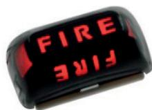
Ripetitore ottico per montaggio a vista. Calotta rossa. Tensione nominale: 5Vdc, 12Vdc, 24Vdc selezionabili, assorbimento 13mA a 5Vdc, 17mA a 12Vdc, 18mA a 24Vdc. Temperatura di funzionamento -15 +55°C. Grado di protezione IP 42. Dimensioni: 75x44x29mm (H x L x P). Peso 40g.
