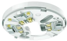
**Base standard per rivelatori analogici** serie ASX, numero 3 contatti ad innesto autopulenti compreso morsetto d'appoggio per schermo, altezza 8 mm, diametro 100 mm, peso 50 g.
