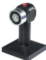
Fermo elettromagnetico per porte tagliafuoco con pulsante di sblocco, forza di ritenuta 50 Kg. - 500 N, terminali a filo, alimentazione 24V, assorbimento 60mA, corpo magnete in acciaio nichelato e base in materiale plastico, colore nero. Completo di staffa altezza 115-130mm e ancoraggio snodato. dim. 105x105x165. Certificato UNI EN 1155:2003
