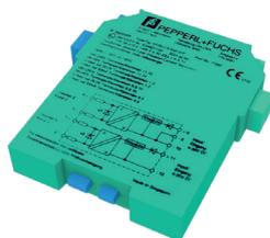
**Barriera a sicurezza intrinseca DC/DC a 2 Canali.** Circuiti di ingresso protetti contro inversione di polarità. Morsettiere estraibili. Montaggio su barra DIN. Certificata per l'uso in Zona 0, IIC, T-4. Compatibile con tutti i nostri dispositivi a sicurezza intrinseca.
