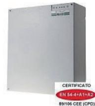
**Unità di alimentazione ausiliaria 24V-3,4A.** Tecnologia switching. 4 uscite a relè per la segnalazione di: mancanza rete, guasto batteria, batteria bassa, guasto alimentatore. Segnalazioni con 4 led esterni per presenza rete e stato batterie. Batterie compatibili 2x7 Ah 12V, 2x18 Ah 12V. Massima corrente disponibile sui carichi: 2,3A (batterie 7Ah e 18Ah). Contenitore metallico bianco di dimensioni 345x385x123 mm (LxHxP). Alimentazione 220Vac 0,9A. Certificato EN54-4:1997+A1:2002+A2:2006
