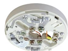
Base per rivelatori convenzionali serie CDX, con uscita a relè NON memorizzante portata dei contatti 1A 30Vdc carico non induttivo, contatti ad innesto autopulenti, morsetto d'appoggio per schermo, altezza 13 mm, diametro 100 mm.
