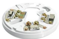
**Base standard per rivelatori convenzionali a sicurezza intrinseca**; contatti ad innesto autopulenti, morsetto d'appoggio per schermo. Materiale ABS altezza 8mm diametro 100mm.
