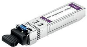
**Ricetrasmittitore** per fibra ottica Monomodale SFP(20Km). Il ricetrasmittitore plug-in da utilizzare con gli analizzatori IAKEDNX-R-2F/FC-K fornisce un collegamento di comunicazione in fibra monomodale tra i ricetrasmittitori sulla rete. Distanza massima tra gli analizzatori 20Km.
