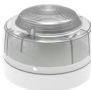
**Lampeggiante a led BIANCO** alimentazione 12-29Vdc assorbimento massimo 26mA, temperatura di funzionamento -25°C +70°C. Contenitore in materiale termoplastico di colore rosso o bianco, con lente trasparente, altezza 72mm diametro 100mm. Grado di protezione IP21C. Certificata EN 54-23 classe C e W.
