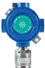
Rivelatore serie SMART3G-C2 per OSSIGENO (O2); Campo di misura 0-25% Vol. Uscita proporzionale 4-20mA. Uscite opzionali a relè tramite scheda ST.S3REL. Alimentazione 12-24Vcc. Protezione IP65. Temperatura di esercizio: -30°C/55°C.
