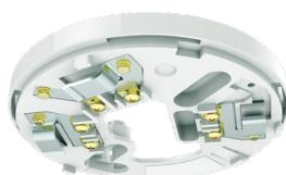
**Base standard per rivelatori convenzionali serie CDX**, contatti ad innesto autopulenti, morsetto d'appoggio per schermo, altezza 8 mm, diametro 100 mm. Materiale ABS di colore AVORIO. Certificato LPCB, Lloyds Register, Germanischer Lloyd, MCA. Certificazione CE secondo MED (Marine Equipment Directive).
