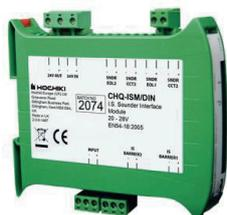
**Modulo di interfaccia per avvisatori ottico-acustici a sicurezza intrinseca** collegati ai moduli avvisatori CHQ-DSC2 o alle uscite avvisatori di centrale. Dotato di 2 uscite per avvisatori (max. 1 avvisatore o lampeggiante per uscita) e 1 ingresso monitorato. Alimentazione esterna 24Vcc. Contenitore per montaggio su barra DIN. Morsettiere estraibili. Dimensioni 119x108x24mm. Certificato EN 54-18:2005. Necessita di barriera a sicurezza intrinseca.
