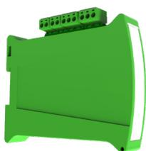
Modulo indirizzato su loop, certificato SIL2, a 2 ingressi singolarmente programmabili come N/A o N/C. Alimentazione diretta dal loop, consumo a riposo 280 micro A. Led di segnalazione. Contenitore per montaggio su barra DIN. Morsettiere estraibili. Dimensioni 119x108x24mm. Completo di isolatori di corto circuito integrati direttamente sul modulo. Certificato EN 54-18:2005 ed EN 54-17:2005. Indirizzamento tramite dip switch presenti sul modulo.
