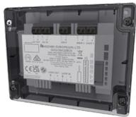
**Modulo indirizzato su loop con 1 ingresso monitorato e 2 uscite controllate per avvisatori** (carico max. 1A ognuna). Alimentazione esterna 24Vcc 2A, consumo sul loop a riposo 350 microA. Led di segnalazione visibili a coperchio chiuso. Contenitore "Smart Fix" con coperchio trasparente. Dimensioni 157x127x35mm. Completo di isolatori di cortocircuito integrati direttamente sul modulo. Certificato EN 54-18:2005 ed EN 54-17:2005. Indirizzamento tramite dip switch presenti sul modulo.
