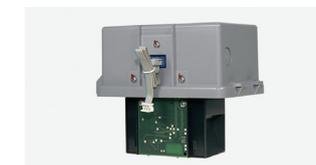
**Rivelatore ottico ad alta sensibilità** per unità di analisi ASD 533-1. Sensibilità allarme: min. 10%-max.0.02 %. Il preallarme può essere impostato fino a 10 volte più sensibile. Es. 0.002% obs/m. Temperatura di lavoro -20°C a +60°C. Dimensioni: 95 (L) x 145 (H) x 120 (P) mm.
