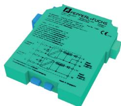
**Barriera a sicurezza intrinseca DC/DC a 1 Canale.** Circuiti di ingresso protetti contro inversione di polarità. Morsettiere estraibili. Montaggio su barra DIN. Certificata per l'uso in Zona 0, IIC, T-4. Compatibile con tutti i nostri dispositivi a sicurezza intrinseca.
