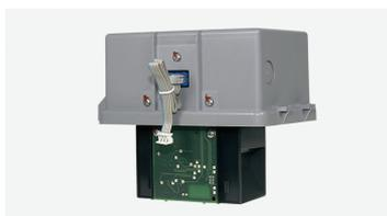
**Rivelatore ottico ad alta sensibilità** per unità di analisi ASD 532. Sensibilità allarme: min. 10%-max.0.02 %. Il preallarme può essere impostato fino a 10 volte più sensibile. Es. 0.002% obs/m. Temperatura di lavoro -20°C a +60°C. Dimensioni: 95 (L) x 145 (H) x 120 (P) mm.
