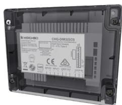
Modulo indirizzato su loop, certificato SIL2, a 2 ingressi singolarmente programmabili come N/A o N/C. Alimentazione diretta dal loop, consumo a riposo 280 microA. Led di segnalazione visibile a coperchio chiuso. Contenitore “Smart Fix” con coperchio trasparente. Dimensioni 157x127x35mm. Completo di isolatori di corto circuito integrati direttamente sul modulo. Certificato EN 54-18:2005 ed EN 54-17:2005. Indirizzamento tramite dip switch presenti sul modulo.
