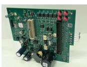
**Scheda di espansione 2° Loop**. Protocollo Hochiki ESP per centrali Syncro AS
