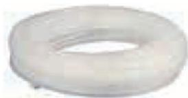
**Tubo in plastica rigida**, per connettere il rivelatore ADW con il tubo sensore (Cu, St, PTFE). Dati tecnici: diametro esterno 5 mm, diametro interno 3 mm, lunghezza 25m. Da utilizzare con accessori: SS 3 CuZn o SS 3 St o SS 4 CuZn. NON funge da sensore di temperatura. Rotolo da 25m.
