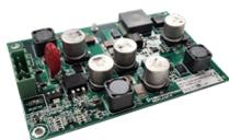
**Scheda di linea aggiuntiva.** Consente di ampliare il sistema e poter collegare un massimo di 254 dispositivi/lampade alla centrale
