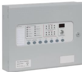
**Sigma CP-R8/A: Pannello Ripetitore** per centrali Sigma a 8 zone. Collegamento tramite linea seriale. Alimentatore 230 Vac./24 Vdc Potenza 1 A. Consumo: 75 mA. a riposo/ 110 mA. Max. in allarme. Batterie ammesse 2x7 Ah/12V. Contenitore metallico grigio RAL 7047. Dimensioni 385x310x90mm.
