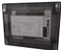
Modulo indirizzato su loop per 2 zone rivelatori convenzionali (20/zona) a sicurezza intrinseca certificato SIL2, alimentazione esterna 24 Vdc, consumo a riposo 330 microA. Led di segnalazione visibile a coperchio chiuso. Contenitore “Smart Fix” con coperchio trasparente. Temperatura di funzionamento -10°C +50°C. Dimensioni 157x127x35mm. Con isolatori di corto circuito integrati nel modulo. Certificato EN 54-18 ed EN 54-17. Necessita di barriera a sicurezza intrinseca.
