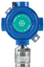
Rivelatore serie SMART3G-C2 per MONOSSIDO DI CARBONIO (CO); Campo di misura 0-500ppm L.I.E. Uscita proporzionale 4-20mA. Uscite opzionali a relè tramite scheda ST.S3REL. Alimentazione 12-24Vcc. Temperatura di esercizio: -30°C/50°C.
