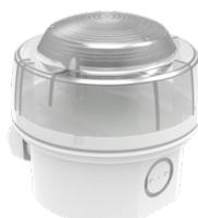
**Lampeggiante a led ROSSO** alimentazione 12-29Vdc assorbimento massimo 26mA, temperatura di funzionamento -25°C 70°C. Contenitore in materiale termoplastico di colore rosso o bianco, con lente trasparente, altezza 97mm diametro 100mm. Grado di protezione IP65. Certificata EN 54-23 classe C e W.
