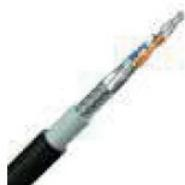
Cavo twistato schermato alluminio + calza in rame stagnato 2 x 2 AWG24. Isolamento conduttori in PE, guaina esterna in PVC antifiama grigio. Isolamento guaina 400V. Guaina esterna diametro 8,4mm. Impedenza caratteristica: 120 ohm, mutua capacità 43pF/m. Conforme alle norme: IEC 60332-1-2, CEI-UNEL 36762, EIA RS485. Classificazione secondo EN50575:ECA
