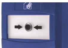
Pulsante incendio convenzionale ripristinabile in ABS di colore BLU, completo di scatola posteriore. Uscita con contatto NA libero o con in serie resistenza da 470 Ohm. Temperatura di funzionamento -30°C +70°C. Grado di protezione IP42. Dimensioni Pulsante 88x87x25 mm (escluso morsettiera). Dimensioni pulsante completo di scatola posteriore 88x87x55 mm. Certificato EN 54-11.
