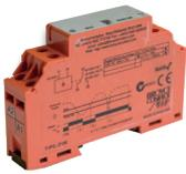
Dispositivo per il controllo della tensione di fase, valuta costantemente lo stato di un circuito di illuminazione. Quando il circuito di illuminazione è considerato difettoso, l'unità dispone di un contatto per il collegamento con il modulo di I/O per la gestione dell'emergenza. Montaggio su guida DIN.
