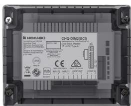
**Modulo indirizzato su loop a 2 ingressi** singolarmente programmabili come N/A o N/C. Alimentazione diretta dal loop, consumo a riposo 280 microA. Led di segnalazione visibile a coperchio chiuso. Contenitore “Smart Fix” con coperchio trasparente. Dimensioni 157x127x35mm. Completo di isolatori di corto circuito integrati direttamente sul modulo. Certificato EN 54-18:2005 ed EN 54-17:2005. Indirizzamento tramite dip switch presenti sul modulo. Certificazione CE secondo MED DNV-GL N.13 976-15 HH.
