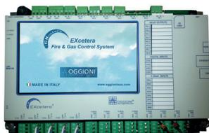
**Centrale Openframe** con display Touch TFT 7". Quattro linee seriali RS485 per un massimo complessivo di 250 dispositivi (rivelatori e moduli di I/O). Una linea seriale per il collegamento verso sistemi remoti BMS. Otto uscite a relè integrate di cui 7 liberamente programmabili. Otto ingressi analogici 4-20mA integrati e quattro ingressi digitali. Alimentazione 24Vdc. Batteria collegabile 7,2Ah. Possibilità di fornirlo nel cabinet cod. EXcetera-BOX10 da ordinare a parte.
