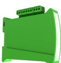
Modulo indirizzato su loop, certificato SIL2, con 2 uscite controllate per avvisatori (carico max. 1A ognuna) e 1 ingresso monitorato. Alimentazione esterna 24Vcc 2A, consumo sul loop a riposo 350 microA. Led di segnalazione. Contenitore per montaggio su barra DIN. Morsettiere estraibili. Dimensioni 119x108x24mm. Completo di isolatori di cortocircuito integrati direttamente sul modulo. Certificato EN 54-18:2005 ed EN 54-17:2005. Indirizzamento tramite dip switch presenti sul modulo.
