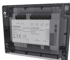
Modulo di interfaccia, certificato SIL2, per avvisatori ottico-acustici a sicurezza intrinseca collegati ai moduli avvisatori CHQ-DSC2(SCI) o alle uscite avvisatori di centrale. Dotato di 2 uscite per avvisatori (max. 1 avvisatore o lampeggiante per uscita) e 1 ingresso monitorato. Alimentazione esterna 24Vcc. Contenitore “Smart Fix” con coperchio trasparente. Dimensioni 157x127x35mm. Certificato EN 54-18:2005. Necessita di barriera a sicurezza intrinseca.
