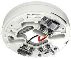
**Base con isolatore di corto circuito** per rivelatori analogici serie Ferroviaria, contatti ad innesto autopulenti, morsetto d'appoggio per schermo, altezza 13,7 mm, diametro 100 mm, peso 79 g. Materiale ABS, colore BIANCO. Certificata EN50155, EN45545-2 Fire hazard level HL1, HL2, HL3, evaluation requirements: R25. Range temperatura funzionamento certificato da -25°C a +70 °C.
