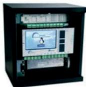
Cabinet 10" **metallico per montaggio a muro** completo di ventolina di raffreddamento termostata, alimentatore 230Vac 250W, 24Vcc, 10,4A e scheda di distribuzione delle alimentazioni.
