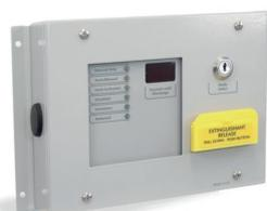
Ripetitore remoto di stato Sigma SI-L per centrale SigmaXT, SigmaXT+ e SyncroXT+. N. 6 segnalazioni luminose + display tempo rimanente. Completo di Chiave Meccanica per selezione modalità di funzionamento Automatico/ Manuale. Pulsante a strappo per Comando Manuale Scarica Immediata. Collegamento tramite linea seriale. Alimentazione 21-30Vcc. Consumo: 33 mA. A riposo/ 70 mA. Max. in allarme; Box Metallico colore grigio RAL 7047 dim. 385x310x90 mm.
