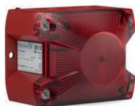
**Lampeggiante allo xeno per interni/esterni.** Energia flash 5 Joule, intensità luminosa 44 cd (portata EN54r=11m) frequenza flash 1Hz. Alimentazione 18-30Vdc assorbimento 300mA a 24Vdc, contenitore in policarbonato e ABS di colore ROSSO. Dimensioni 110x85x81 mm (LxHxP forma parallelepipedo). Grado di protezione IP66. Temperatura di esercizio -40° +55°C. Certificata EN54-23, VdS, UL.
