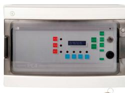
**Centrale PL4+.** Centrale gas con display LCD. Nr. 4 rivelatori 4-20mA collegati alla centrali espandibili a 8 con l'aggiunta di scheda opzionale per altri 4 rivelatori 4-20mA. Nr. 5 relè di uscita di cui 3 associate alle soglie di intervento (AL1, AL2, AL3), una al guasto ed una associabile ad uno dei tre stati di allarme o al guasto. Contenitore in ABS IP65 dim. 486x288x148 mm. Alimentazione 230Vac +/-10% 50Hz selezionabile tramite switch. Supporta nr.2 batterie da 12V 7Ah.
