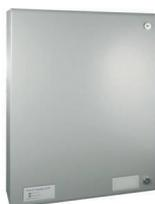
**Unità di alimentazione ausiliaria 24V-10,25A.** Uscita a relè, contatto portata 30Vdc 1A, per la segnalazione di guasto. Batterie compatibili 2x12V 45 Ah. Massima corrente disponibile sui carichi: 8A. Contenitore metallico di dimensioni 500x460x190 mm (LxHxP). Certificato EN54-4.
