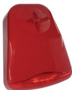
**Sirena di potenza multifunzione per esterni**. Comando ad inversione di polarità, programmazione modulazioni, programmazione lampeggio flash. Pressione sonora: 100dB (A) a 1m. Trasduttore acustico: Magnetodinamica 8ohm. Lampeggiante: LED alta luminosità. Tensione nominale: 24 Vcc. Corrente massima: 350mA, temperatura di funzionamento -25°C a +70°C. Contenitore di colore ROSSO. Grado di protezione: IP 33. Dimensioni: 240 x 283 x 82mm (L x H x P). Peso: 1700g.
