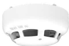
Rivelatore combinato termomassimale + termovelocimetrico analogico indirizzato certificato SIL2, indirizzamento elettronico, doppio Led di segnalazione (verde in polling, rosso in allarme), consumo 350 microA, basso profilo, altezza 45mm, diametro 100 mm. Materiale ABS. Certificato EN54-5. Compatibile con le basi della serie YBN-R/3-SCI/SIL e YBN-R/3 in funzione del colore del rivelatore. Necessita del programmatore portatile TCH-B200 per l'indirizzamento.
