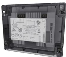
**Modulo indirizzato su loop con 1 ingresso monitorato e 1 uscita a relè** con contatto in scambio libero da tensione, portata 48Vcc/2A – 250Vca/5A (carico resistivo). Alimentazione diretta da loop, consumo a riposo 300 micro A. Dimensioni 157x127x35mm. Completo di isolatori di corto circuito integrati direttamente sul modulo. Certificato EN 54-18:2005 ed EN 54-17:2005. Indirizzamento tramite dip switch presenti sul modulo.
