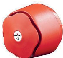
Sirena elettronica convenzionale a basso assorbimento, completa di base, potenza acustica 110 dB a 1 m, 32 toni selezionabili; alimentazione 9-30Vdc assorbimento 6-39mA, temperatura di funzionamento da -40°C a +70°C. Contenitore in materiale termoplastico colore ROSSO, altezza 85mm diametro 92mm. Grado di protezione IP45. Certificata EN 54-3.
