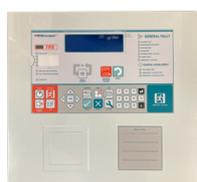
**Pannello remoto per centrale FIREscape+**. Collegamento tramite linea seriale RS485 massima distanza 500m con cavo CAT6. Alimentazione 15-40Vdc assorbimento 150mA. Dimensione 400x433x60mm (HxLxP)
