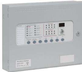
**Sigma CP-R2/A: Pannello Ripetitore** per centrali Sigma a 2 zone. Collegamento tramite linea seriale. Alimentatore 230 Vac./24 Vdc Potenza 1 A. Consumo: 75 mA. a riposo/ 110 mA. Max. in allarme. Batterie ammesse 2x7 Ah/12V. Contenitore metallico grigio RAL 7047. Dimensioni 385x310x90mm.
