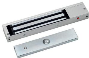
Fermo elettromagnetico per porte di sicurezza. Utilizzato generalmente per mantenere chiuse le porte di sicurezza, uscite di emergenza, porte antipanico, di accesso e di passaggio in generale. Forza di tenuta 150Kg. Alimentazione 12/24Vdc assorbimento 380/215mA. Led indicatore di stato e relàcon contatti NA/NC. Dimensioni 210x40x21. Completo di contropiastra dimensioni 130x33x11.
