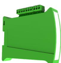
Modulo di interfaccia, certificato SIL2, per avvisatori ottico-acustici a sicurezza intrinseca collegati ai moduli avvisatori CHQ-DSC2 o alle uscite avvisatori di centrale. Dotato di 2 uscite per avvisatori (max. 1 avvisatore o lampeggiante per uscita) e 1 ingresso monitorato. Alimentazione esterna 24Vcc. Contenitore per montaggio su barra DIN. Morsettiere estraibili. Dimensioni 119x108x24mm. Certificato EN 54-18:2005. a sicurezza intrinseca.
