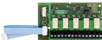
Scheda 5 uscite a relè aggiuntive per unità di rivelazione ADW 535. I relè sono liberamente programmabili per le segnalazioni di Guasto, Allarme e Pre-allarme. Dimensioni: 95x58x17 mm (HxLxP)
