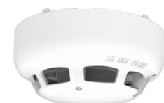
**Rivelatore combinato termomassimale + termovelocimetrico analogico indirizzato**, indirizzamento elettronico, doppio Led di segnalazione (verde in polling, rosso in allarme), consumo 350 microA, basso profilo, altezza 45mm, diametro 100 mm. Certificato EN54-5. Compatibile con le basi della serie YBN-R/3M e YBN-R/3(SCI)M. Necessita del programmatore portatile TCH-B200 per l'indirizzamento. Certificazione CE secondo MED DNV-GL N.13 973-15 HH
