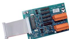
**Scheda Input/Output** per unità di analisi FireLink 25/100. Fornisce 4 uscite a relè per segnalazione di allarme e 1 di guasto. Inoltre è dotata di 3 ingressi programmabili per le seguenti funzioni: Day/Night mode, Remote Reset, Remote Isolate, Classifire Override, Fault ext. power supply.
