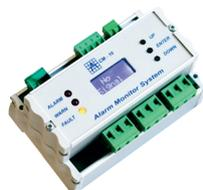
**Centralina montaggio barra DIN** - 1 input 4-20mA. 3 Livelli di allarme programmabili + 3 uscite relè programmabili in funzione delle logiche richieste. Tipo gas, unità di misura, fondo scala programmabili da utilizzatore.
