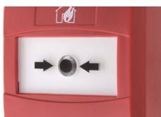
Pulsante incendio convenzionale ripristinabile in ABS di colore ROSSO, completo di scatola posteriore. Uscita con contatto NA libero o con in serie resistenza da 470 Ohm. Temperatura di funzionamento -30°C +70°C. Grado di protezione IP42. Dimensioni Pulsante 88x87x25 mm (escluso morsettiera). Dimensioni pulsante completo di scatola posteriore 88x87x55 mm. Certificato EN 54-11.
