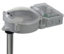
**Camera di analisi per condotte d'aria** compatibile con le basi YBN-R/3, YBN-R/3(SCI), YBN-R/6, YBN-R/6SK, YBO-R/6R, YBO-R/6RN, YBO-R/6RS e loro varianti. Compreso tubo di campionamento per presa/rimando da 600mm (deve essere praticato un solo foro sulla condotta), struttura in ABS con camera ispezionabile, dimensioni esterne 280x150x100 mm. Direttamente installabile su canali d'aria a sezione quadrata mentre per quelle a sezione circolare richiede le staffe di montaggio cod. SDP-3 BRAKET.
