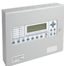
Centrale antiallagamento LEAKalarm con 2 Loop per 127 dispositivi (protocollo ESP) per loop, display grafico 240x64 pixel, gestione nella massima configurazione di 508 sensori perdita acqua per un totale di 25.400 m di cavo sensore. Batterie in tampone richiesta: 2x7 Ah/12V (esclusa). Alimentatore 3A-24Vcc. Armadio metallico 385x310x90 mm.
