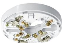
Base per rivelatori convenzionali serie CDX per sistemi a 2 fili dove i rivelatori e gli avvisatori sono sullo stesso cavo di zona (verificare compatibilità della centrale), contatti ad innesto autopulenti, morsetto d'appoggio per schermo e altezza 8 mm, diametro 100 mm.
