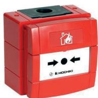
**Pulsante incendio convenzionale ripristinabile** in MPO di colore ROSSO, versione weatherproof, completo di vetrino infrangibile antinfortunistico. Uscita con contatto NA libero o con in serie resistenza da 470 Ohm. Temperatura di funzionamento -25°C +70°C. Grado di protezione IP67. Dimensioni 98x94x78 mm. Certificato EN 54-11.
