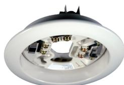
**Adattatore per montaggio ad incasso** dei rivelatori serie ASX e CDX. Materiale in ABS di colore AVORIO. Compatibile con le basi della serie YBN, YBO-R/5, YBO-R/6, YBO-R/4, YBV-R/4. Altezza 44 mm (incassato 7mm), diametro 140 mm, peso 65 g. Deve essere completato con il fissaggio cod. YYA-A per controsoffitto
