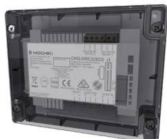
Modulo indirizzato su loop, certificato SIL2, con 2 uscite a relé con contatto in scambio libero da tensione e 1 ingresso monitorato, portata relè 30Vcc/1A (carico resistivo).
