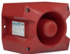
**Sirena elettronica ad alta potenza sonora**, completa di back box per entrata cavi, potenza acustica 110 dB (portata EN54 r=56m), 80 toni selezionabili, alimentazione 10-60Vdc assorbimento 60-485mA, temperatura di funzionamento -40° +55°C. Contenitore in policarbonato e ABS di colore ROSSO. Dimensioni 214x170x156 mm (LxHxP). **Grado di protezione IP66**. Certificata EN 54-3, VdS, GOST, UL, GL (codice d'ordine specifico per GL).
