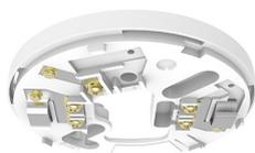
Base standard per rivelatori analogici serie ASX, contatti ad innesto autopulenti, morsetto d'appoggio per schermo, altezza 8 mm, diametro 100 mm, peso 50 g. Materiale ABS di colore BIANCO. Da utilizzare sia per le lampade che per i segnali di sicurezza.
