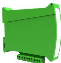
**Modulo Indirizzato su Loop n. 2 ingressi** 4-20 mA per connessione di Dispositivi Tecnologici e/o apparati standard. Alimentazione diretta dal loop; Contenitore per montaggio su barra DIN. Consumo a riposo 300 microA. Dimensioni 119x108x24mm. Indirizzamento tramite dip switch presenti sul modulo. Certificato EN50155, EN45545-2 Fire hazard level HL1, HL2, HL3, evaluation requirement: R25. Range temperatura funzionamento certificato da -25°C a +70 °C.
