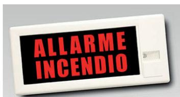
**Pannello ottico/acustico con buzzer**, LED ad alta efficienza, suono pulsante, potenza acustica min. 79db(A) 1m MAX 92,3 dB(A), alimentazione 18-30dc, assorbimento a 24Vcc 50 mA, temperatura di funzionamento -10°C +55°C. Contenitore in termoplastico autoestinguente BIANCO completo di scritta "ALLARME INCENDIO", grado di protezione IP21C. Dimensioni 292x130x55mm. Certificato EN 54-3 e EN54-23, UNI11744
