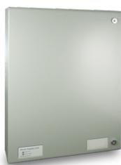
**Unità di alimentazione ausiliaria 24V-5,25A.** Uscita a relè, contatto portata 30Vdc 1A, per la segnalazione di guasto. Batterie compatibili 2x12V 12 Ah. Massima corrente disponibile sui carichi: 5,25A. Contenitore metallico di dimensioni 385x520x110 mm (LxHxP). Alimentazione 220Vac 50/60Hz o 110Vac 50/60Hz. Certificato EN54-4.
