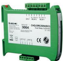
Modulo indirizzato su loop con 1 ingresso monitorato e 2 uscite a relé con contatto in scambio libero da tensione, portata 30Vcc/1A (carico resistivo). Alimentazione diretta da loop, consumo a riposo 300 microA. Led di segnalazione. Contenitore per montaggio su barra DIN. Morsettiere estraibili. Dimensioni 119x108x24mm. Completo di isolatori di corto circuito integrati direttamente sul modulo. Certificato EN 54-18:2005 ed EN 54-17:2005. Indirizzamento tramite dip switch presenti sul modulo.
