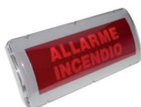
**Pannello ottico/acustico** tipo "W", LED bianchi ad alta efficienza, min. 85,4 dB(A) suono standard assorbimento 56mA, max 96,6 dB(A) 1m suono potenziato assorbimento 90mA, alimentazione 24-28Vdc, temperatura di funzionamento -10°C +55°C. Completo di scritta "ALLARME INCENDIO", grado di protezione IP54. Dimensioni 331x150x68mm. Certificato EN 54-3 e EN54-23.
