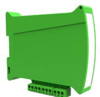
Modulo Indirizzato su Loop n. 2 ingressi 4-20 mA per connessione di Dispositivi Tecnologici e/o apparati industriali standard. Alimentazione diretta dal loop; Contenitore per montaggio su barra DIN. Alimentazione diretta dal loop; consumo a riposo 300 microA.
