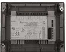
**Modulo indirizzato su loop per 2 zone** rivelatori convenzionali (30/zona) o rivelatori lineari di fumo. SPC-ET (max 3 per zona), alimentazione esterna 24 Vdc, consumo a riposo 330 microA. Led di segnalazione visibile a coperchio chiuso. Contenitore “Smart Fix” con coperchio trasparente. Dimensioni 157x127x35mm. Completo di isolatori di corto circuito integrati direttamente sul modulo. Certificato EN 54-18 ed EN 54-17. Indirizzamento tramite dip switch presenti sul modulo.
