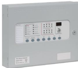
**Sigma CP-R4/A: Pannello Ripetitore** per centrali Sigma a 4 zone. Collegamento tramite linea seriale. Alimentatore 230 Vac./24 Vdc Potenza 1 A. Consumo: 75 mA. a riposo/ 110 mA. Max. in allarme. Batterie ammesse 2x7 Ah/12V. Contenitore metallico grigio RAL 7047. Dimensioni 385x310x90mm.
