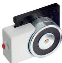
Fermo elettromagnetico per porte tagliafuoco con pulsante di sblocco, forza di ritenuta 50 Kg. - 500 N, terminali a filo, alimentazione 24V, assorbimento 60mA, corpo magnete in acciaio nichelato e base in materiale plastico, colore bianco. Completo di ancoraggio snodato. dim. 68x84x30. Certificato UNI EN 1155:2003
