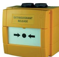
**Pulsante incendio convenzionale ripristinabile** in MPO di colore GIALLO, versione weatherproof, completo di vetrino infrangibile antinfortunistico. Uscita con contatto NA libero o con in serie resistenza da 470 Ohm. Temperatura di funzionamento -25°C +70°C. Grado di protezione IP67. Dimensioni 98x94x67 mm. Certificato EN 54-11.
