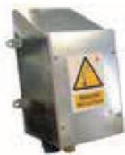
**Box riscaldatore** per sistemi aspirazione FIRELINK. Consente di riscaldare l'aria all'interno dei tubi prima che venga immessa all'interno delle unità di aspirazione nei casi in cui tale temperatura sia inferiore ai -10°C e si possano generare fenomeni di condensazione. Contenitore in materiale metallico zincato. Alimentazione 220Vac max.200W.
