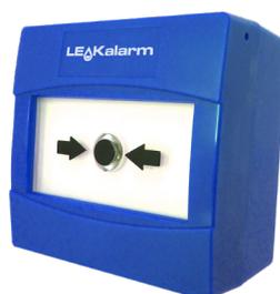
**Pulsante convenzionale** ripristinabile in MPO colore BLU, completo di scatola posteriore. Uscita con contatto NA libero o con in serie resistenza da 470 Ohm. Temperatura di funzionamento -10°C +55°C. Grado di protezione IP24. Dimensioni Pulsante 89x93x27,5 mm. Dimensioni Pulsante completo di scatola posteriore 89x93x59,5 mm.
