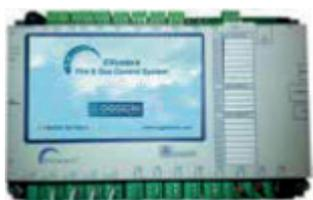
Centrale **Open frame** per parcheggi con display Touch TFT 7". Quattro linee seriali RS485 per un massimo complessivo di 250 dispositivi (rivelatori e moduli di I/O). Una linea seriale per il collegamento verso sistemi remoti. Otto uscite a relè integrate di cui 7 liberamente programmabili. Otto ingressi analogici 4-20mA integrati e quattro ingressi digitali. Alimentazione 24Vdc. Batteria collegabile 7,2Ah. Conforme EN50545. Possibilità di fornirlo nel cabinet cod. EXcetra-BOX10
