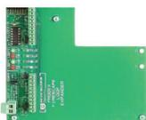
**Scheda di supporto per centrale FIREscape+** per l'espansione di ulteriori 2 loop (scheda loop non compresa)
