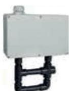
**Dispositivo per la raccolta e lo scarico dell'acqua** che si viene a creare all'interno delle tubazioni in ambienti molto umidi a causa della condensazione. Adatto per montaggio su tubi ABS Diam. 25 mm. Materiale: ABS. Dimensioni: 335x250x90 mm.
