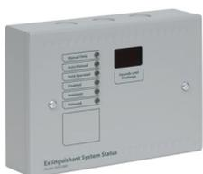
Ripetitore remoto di stato Sigma SI-M per centrale SigmaXT, SigmaXT+ e SyncroXT+. N. 6 segnalazioni luminose + display tempo rimanente. Completo di Chiave Meccanica per selezione modalità di funzionamento Automatico/ Manuale. Collegamento tramite linea seriale. Alimentazione 21-30 Vcc. Consumo: 33 mA. A riposo/ 70 mA. Max. in allarme; Box Metallico colore grigio RAL 7047 dim. 385x310x90 mm.
