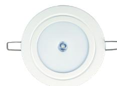
Lampada per spazi aperti per installazione ad incasso a LED ad alta luminosità, indirizzabile, utilizza la moderna tecnologia a LED. Utilizza una coppia di conduttori per l'alimentazione e la comunicazione. Il corpo dell'unità contiene gli elementi elettronici e la batteria di riserva ed è dotata di un LED bicolore che indica lo stato di carica/guasto (verde per la carica, rosso per il guasto). Necessita di pacco batterie ILHOLI-ION/2900.
