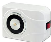
Fermo elettromagnetico per porte tagliafuoco con pulsante di sblocco, forza di ritenuta 50 Kg. - 500 N, terminali a filo, alimentazione 24V, assorbimento 60mA, corpo magnete in acciaio nichelato e base in materiale plastico, colore bianco. Completo di ancoraggio snodato. dim. 72x105x40. Certificato UNI EN 1155:2003
