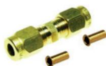
**Set in ottone** per giuntare due tubi sensore in teflon in ambienti con temperature superiori a 100°C, diametro tubi 6 mm, composto da connettore SJ 6/4 CuZn e manicotto SS4 CuZn.
