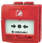
**Pulsante manuale convenzionale, ripristinabile, versione a sicurezza intrinseca** (classif. ATEX: II 1G EEx ia IIC T4 Tamb.= 55° per Area Cat. 1). Temperatura di funzionamento -25°C +70°C. Grado di protezione IP67. Contenitore ABS colore ROSSO, dim.: 98x94x78 mm; Certificato BS 5839 - Parte 2; Certificato EN 54-11. ATEX (BASEEFA). Necessita barriera zener a sicurezza intrinseca.
