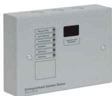
Ripetitore remoto di stato Sigma SI-S per centrale SigmaXT, SigmaXT+ e SyncroXT+. N. 6 segnalazioni luminose + display tempo rimanente. Collegamento tramite linea seriale. Alimentazione 21-30 Vcc. Consumo: 33 mA. A riposo/ 70 mA. Max. in allarme; box metallico colore grigio RAL 7047 dim. 385x310x90 mm.
