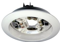
Adattatore per montaggio ad incasso dei rivelatori serie ASX e CDX. Materiale in ABS. Compatibile con le basi della serie YBN, YBO-R/5, YBO-R/6, YBO-R/4, YBV-R/4. Altezza 44 mm (incassato 7mm), diametro 140 mm, peso 65 g. Deve essere completato con il fissaggio cod. YYA-A per controsoffitto
