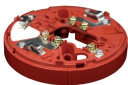
**Base con isolatore** di corto circuito per sirene CHQ-WS2 e CHQ-WSB2/, numero 3 contatti ad innesto autopulenti compreso morsetto d'appoggio per schermo, altezza 13 mm, diametro 100 mm, peso 60 g. Certificato EN 54-17:2005. Colore ROSSO.
