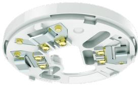
**Base con isolatore di corto circuito** per rivelatori analogici serie ASX, contatti ad innesto autopulenti, morsetto d'appoggio per schermo, altezza 13,7 mm, diametro 100 mm, peso 79 g. Certificata EN 54-17. Materiale ABS. Certificazione CE secondo MED (Marine Equipment Directive).
