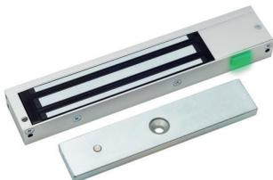
Fermo elettromagnetico per porte di sicurezza. Utilizzato generalmente per mantenere chiuse le porte di sicurezza, uscite di emergenza, porte antipanico, di accesso e di passaggio in generale. Forza di tenuta 300Kg. Alimentazione 12/24Vdc assorbimento 530/290mA. Led indicatore di stato e relàcon contatti NA/NC. Dimensioni 250x48x24. Completo di contropiastra dimensioni 180x38x11.
