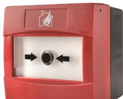
**Pulsante incendio convenzionale ripristinabile in ABS** di colore ROSSO, completo di scatola posteriore. Uscita con contatto NA libero o con in serie resistenza da 470 Ohm. Temperatura di funzionamento -30°C +70°C. Grado di protezione IP67. Dimensioni pulsante completo di scatola posteriore 88x87x73 mm (escluso pressacavi). Certificato EN 54-11.
