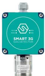
Rivelatore serie SMART3G-C3 per gas METANO (CH4); Campo di misura 0-100% L.I.E. Uscita proporzionale 4-20mA. Uscite opzionali a relè tramite scheda ST.S3REL. Alimentazione 12-24Vcc. Temperatura di esercizio: -40°C/+60°C.
