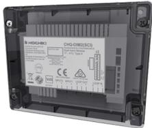
**Modulo indirizzato su loop a 2 ingressi** singolarmente programmabili Alimentazione diretta dal loop, consumo a riposo 280 microA. Led di segnalazione visibile a coperchio chiuso. Contenitore “Smart Fix” con coperchio trasparente. Dimensioni 157x127x35mm. Completo di isolatori di corto circuito integrati direttamente sul modulo. Certificato EN 54-18:2005 ed EN 54-17:2005. Indirizzamento tramite dip switch presenti sul modulo.
