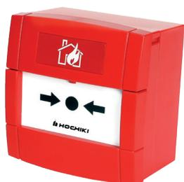
**Pulsante incendio convenzionale ripristinabile** in MPO colore ROSSO, completo di scatola posteriore (SR). Uscita con contatto NA libero con resistenza da 470 Ohm in serie. Temperatura di funzionamento -25°C +70°C. Grado di protezione IP24. Dimensioni Pulsante 89x93x27,5 mm. Dimensioni Pulsante completo di scatola posteriore 89x93x59,5 mm. Certificato EN 54-11. Approvazione DNV-GL.
