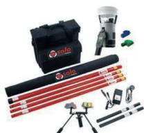
Kit per test sensori, completo di sistema testifire 1001-001 per rivelatori ottici e termici, SOLO 200 attrezzo per la rimozione sensori, SOLO 100 palo telescopico 4,5m, 3 prolunghe SOLO 101 da 1,13m cad. per palo telescopico, 2 batterie a bastone, carica batteria rapido, 1 capsula per fumo TS3-001, borsone di trasporto.
