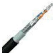
Cavo twistato schermato alluminio + calza in rame stagnato 1 x 2 AWG24. Isolamento conduttori in PE, guaina esterna termoplastico LSZH di colore verde. Isolamento guaina 400V. Guaina esterna diametro 5,8mm. Impedenza caratteristica: 120 ohm, mutua capacità 43pF/m. Conforme alle norme: CEI EN 60332-1-2, IEC 754-1/2, IEC 61034, CEI-UNEL 36762, EIA RS485. Classificazione secondo EN50575: Cca-s1a,d1,a1.
