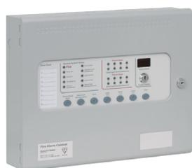
**Sigma CP-R4: Pannello Ripetitore** per centrali Sigma a 4 zone. Collegamento tramite linea seriale. Alimentazione 21-30 Vcc. Consumo: 75 mA. A riposo/ 110 mA. Max. in allarme. Contenitore metallico grigio RAL 7047. Dimensioni 385x310x60 mm.
