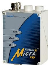
**Stratos MICRA 10.** Sistema ASD ad 1 Tubo, Lungh. Max.50 m totali/ 10 Fori. Sistema di Rivelazione ad Alta Sensibilità con Laser. Sensibilità 0,03% - 25% (%obs/m). Soglie di Allarme 4: (Fire 2, Fire 1, Pre-Alarm and Aux). Uscita di Allarme: 1 Relè/ altri disponibili. Programmazione: tramite Porta Seriale RS-232. Temperatura di Funzionamento: -10°C/ +60°C. Alimentazione 24 Vdc (21,6 - 26,4) / 250 mA. Certificazione secondo EN 54-20. Dimensioni: 145x220x90 mm/ Peso: 1,7 Kg
