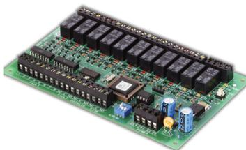
**Scheda remota per uscite ausiliarie a relè.** Collegamento alla centrale tramite linea seriale RS-485. Una uscita a relè per ogni singola zona, una uscita a relè di allarme incendio generale, una uscita a relè di guasto generale e una uscita a relè di coincidenza di allarmi (allarme su almeno due linee). Alimentazione 21-30 Vcc. Consumo: 20 mA. A riposo/ 200 mA. Max. in allarme. Dim.: 155x135x30 mm.
