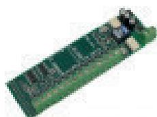
Scheda di espansione ingressi per comunicatori IRIS-4. Consente di aggiungere 12 ingressi liberamente configurabili al comunicatore IRIS-4. Si innesta direttamente sulla scheda del comunicatore ed è configurabile tramite LCD touch screen.
