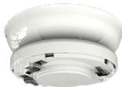
**Sirena basso assorbimento indirizzata su loop**. 51 tonalità selezionabili, volume selezionabile da 50 a 98 dB(A), tempo di suonata impostabile fino a 18 ore. Può fungere da base per un rivelatore o essere montata da sola con coperchio serie SI/CAP2 in quest'ultimo caso necessita del programmatore portatile TCH-B200 per l'indirizzamento. Grado di protezione IP21. Certificata EN54-3. Compatibile con le basi della serie YBN-R/3, YBN-R/3(SCI) e YBV-R/4 in funzione del colore della sirena.
