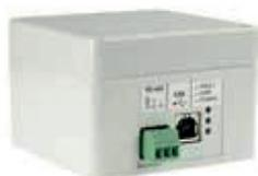
**Convertitore RS485-USB** per la connessione di un PC alla rete di centrali, per sistemi SECURIRAS ASD532 e ASD535. La scheda si alimenta tramite la porta USB. In contenitore plastico di dimensioni 82x89x55mm (HxLxP).
