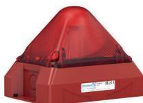
**Lampeggiante allo xeno per interni/esterni.** Energia flash 10 Joule, intensità luminosa 118 cd (portata EN54 r=17m). Alimentazione 24Vdc assorbimento 540mA, contenitore in policarbonato e ABS di colore ROSSO. Dimensioni 166x114x124 mm (LxHxP). Grado di protezione IP66. Temperatura di esercizio -40° +55°C. Certificata EN54-23, VdS, UL.
