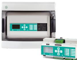
**Centrale PL4+D.** Centrale gas per montaggio su barra DIN a 9 moduli standard con display LCD, Max. 4 rivelatori direttamente collegati alla centrali e 8 aggiuntivi tramite la linea seriale con collegamento a cascata sul loop RS485 o rivelatori analogici 4-20 mA tramite modulo 8 ingressi. Nr. 5 relè di uscita preconfigurabili a bordo più max 16 uscite supplementari tramite modulo esterno. Alimentazione 24Vdc.
