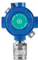
**Rivelatore serie SMART3G-C2** per gas METANO (CH<sub>4</sub>); Campo di misura 0-100% L.I.E. Uscita proporzionale 4-20mA. Uscite opzionali a relè tramite scheda ST.S3REL. Alimentazione 12-24Vcc. Protezione IP65. Temperatura di esercizio: -30°C /+55°C.
