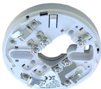
**Base con isolatore di corto circuito per sirene** CHQ-WS2 e CHQ-WSB2/, numero 3 contatti ad innesto autopulenti compreso morsetto d'appoggio per schermo, altezza 13 mm, diametro 100 mm, peso 60 g. Certificato EN 54-17:2005. Colore BIANCO.
