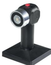
Fermo elettromagnetico per porte tagliafuoco con pulsante di sblocco, forza di ritenuta 100 Kg. - 1000 N, terminali a filo, alimentazione 24V, assorbimento 100mA, corpo magnete in acciaio nichelato e base in materiale plastico, colore nero. Completo di staffa altezza 115-130mm e ancoraggio snodato. dim. 105x105x165. Certificato UNI EN 1155:2003
