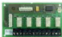
**Scheda 5 uscite a relè addizionali** per unità aspirazione ASD 535. I relè sono liberamente programmabili per le segnalazioni di Guasto, Allarme e Pre-allarme. Max. 2 schede per unità di aspirazione. Dimensioni: 95x58x17 mm (HxLxP)
