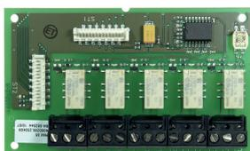
Scheda interfaccia RS-485 per la connessione dell'unità Securisense ADW535 ad un PC o per il collegamento in rete con le altre unità Securisense ADW535 (max. 255) Dimensioni: 95x58x17 (HxLxP).
