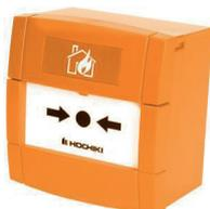
**Pulsante incendio convenzionale ripristinabile** in MPO colore ARANCIONE, completo di scatola posteriore (SR). Uscita con nr. 2 contatti in scambio liberi da tensione. Temperatura di funzionamento -10°C +55°C. Grado di protezione IP24. Dimensioni Pulsante 89x93x27,5 mm. Dimensioni Pulsante completo di scatola posteriore 89x93x59,5 mm. Certificato EN 54-11.
