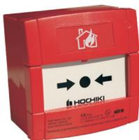
**Pulsante incendio convenzionale, ripristinabile, versione a sicurezza intrinseca** (classif. ATEX: II 1G EEx ia IIC T4 Tamb.= 55° per Area Cat. 1). Temperatura di funzionamento -10°C +55°C. Grado di protezione IP24. Contenitore ABS colore ROSSO, dim.: 88x88x52 mm. (con scatola posteriore per montaggio a giorno). Certificato BS 5839 - Parte 2; Certificato EN 54-11. ATEX (BASEEFA). Necessita barriera a sicurezza intrinseca.
