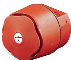
Sirena elettronica convenzionale a basso assorbimento, completa di base rialzata, potenza acustica 110 dB a 1 m., 32 toni selezionabili, alimentazione 9-30Vdc assorbimento 6-39mA, temperatura di funzionamento da -40°C a +70°C. Contenitore in materiale termoplastico colore ROSSO, altezza 105mm diametro 92mm. Grado di protezione IP66. Certificata EN 54-3.
