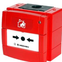
Pulsante incendio, certificato SIL2 con protocollo ESP completo di isolatore di corto circuito, ripristino con apposita chiavetta in dotazione che non richiede la sostituzione dell' elemento infrangibile. Costruzione in MPO di colore ROSSO. Consumo tipico 250 microA a riposo e 5 mA in allarme. Grado di protezione IP67. Dimensioni pulsante 98x94x78 mm. Certificato EN 54-11 ed EN 54-17. Necessita di programmatore portatile TCH-B200 tramite cavetto PL-3 per l'indirizzamento.
