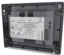
**Modulo indirizzato su loop per 1 zona** di rivelatori convenzionali (max. 6 rivelatori) o per un rivelatore lineare SPC-ET. Alimentazione diretta dal loop, consumo a riposo 260 micro A. Led di segnalazione visibile a coperchio chiuso. Contenitore “Smart Fix” con coperchio trasparente. Dimensioni 157x127x35mm. Completo di isolatori di corto circuito integrati direttamente sul modulo. Certificato EN 54-18:2005 ed EN 54-17:2005. Indirizzamento tramite dip switch presenti sul modulo.
