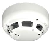
Rivelatore combinato termomassimale + termovelocimetrico analogico indirizzato, con isolatore di corto circuito, indirizzamento elettronico, doppio Led di segnalazione (verde in polling, ambrata se isolato, rosso in allarme), consumo 350 microA, basso profilo, altezza 45mm, diametro 100 mm. Certificato EN54-5, EN54-17. Compatibile con le basi della serie YBV-R/4 in funzione del colore del rivelatore. Necessita del programmatore portatile TCH-B200 per l'indirizzamento.
