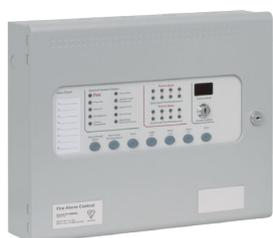
**Sigma CP-R2: Pannello Ripetitore** per centrali Sigma a 2 zone. Collegamento tramite linea seriale. Alimentazione 21-30 Vcc. Consumo: 75 mA. A riposo/ 110 mA. Max. in allarme. Contenitore metallico grigio RAL 7047. Dimensioni 385x310x60 mm.
