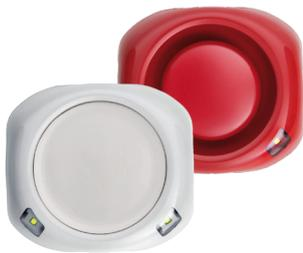
**Sirena elettronica convenzionale**. Possibilità di selezionare 4 volumi di suono differenti, potenza acustica massima 105 dB(A) a 1 m, possibilità di comandare 2 toni separatamente, 32 toni selezionabili. Alimentazione 9-60Vdc, assorbimento 4mA a 105dB(A). Temperatura di funzionamento da -10°C a +55°C 95%RH. Contenitore di colore rosso o bianco. Dimensioni 63x118x121 (HxWxL). **Grado di protezione IP65**. Certificata EN 54-3.
