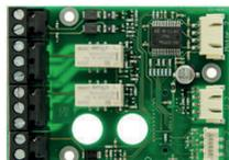
Scheda di ricambio per secondo sensore rivelatore ADW 535-2. Dimensioni: 74x54x35mm
