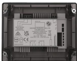
**Modulo indirizzato su loop** con 1 uscita a relé con contatto in scambio libero da tensione, portata 48Vcc/2A – 250Vca/5A (carico resistivo) e 1 ingresso monitorato. Alimentazione diretta da loop, consumo a riposo 300 micro A. Dimensioni 157x127x35mm. Completo di isolatori di corto circuito integrati direttamente sul modulo. Certificato EN 54-18:2005 ed EN 54-17:2005. Indirizzamento tramite dip switch presenti sul modulo.
