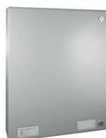
**Unità di alimentazione ausiliaria 24V-10,25A.** Uscita a relè, contatto portata 30Vdc 1A, per la segnalazione di guasto. Batterie compatibili 2x12V 18 Ah. Massima corrente disponibile sui carichi: 8A. Contenitore metallico di dimensioni 500x355x117 mm (LxHxP). Certificato EN54-4.
