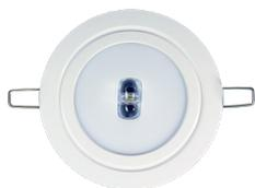
Lampada per corridoio per installazione ad incasso a LED ad alta luminosità, indirizzabile, utilizza la moderna tecnologia a LED. Utilizza una coppia di conduttori per l'alimentazione e la comunicazione. Il corpo dell'unità contiene gli elementi elettronici e la batteria di riserva ed è dotata di un LED bicolore che indica lo stato di carica/guasto (verde per la carica, rosso per il guasto). Necessita di pacco batterie ILHOLI-ION/2900.
