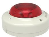
Lampeggiante a LED alta luminosità tensione di funzionamento da 17 a 41 Vdc, assorbimento massimo 5mA, temperatura di funzionamento -10°C +50°C. Contenitore di colore BIANCO, stessa forma dei rivelatori della serie CDX. Necessita di base YBN-R/6(WHT).
