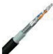
Cavo twistato schermato alluminio + calza in rame stagnato 1 x 2 AWG24. Isolamento conduttori in PE, guaina esterna in PVC antifiama grigio. Isolamento guaina 400V. Guaina esterna diametro 5,5mm. Impedenza caratteristica: 120 ohm, mutua capacità 43pF/m. Conforme alle norme: IEC 60332-1-2, CEI-UNEL 36762, EIA RS485. Classificazione secondo EN50575:ECA.
